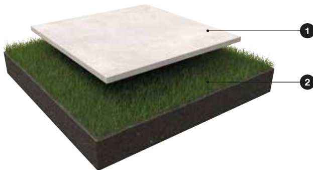
Posa diretta - Direct installation - Pose directe - Direktverlegung
